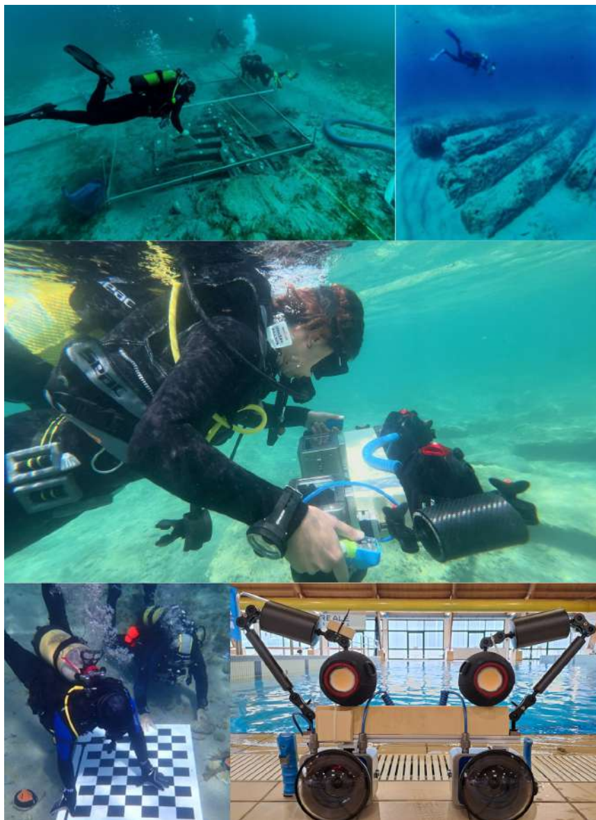
Documentazione fotogrammetrica subacquea su siti archeologici sommersi: test e calibrazione di un sistema bicamera sincronizzato, rilievi in situ su relitti e strutture sommerse, e fasi preliminari di sperimentazione in piscina / Underwater photogrammetric documentation of submerged archaeological sites: testing and calibration of a synchronized bicamera system, in situ surveys of wrecks and submerged structures, and preliminary experimentation in a pool environment
