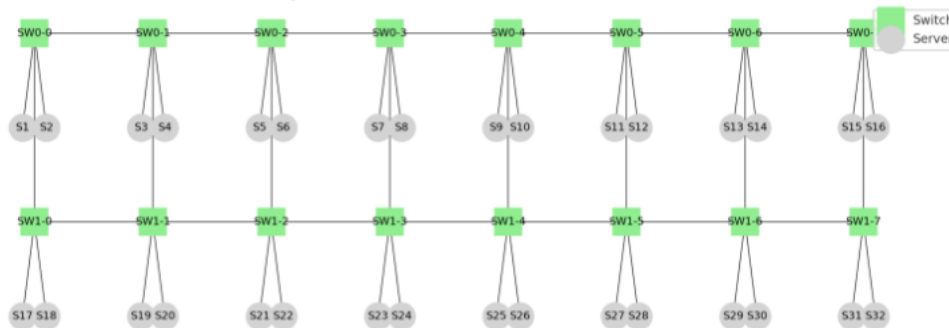
Esempio di 2D-Torus (2x8, 32 server)
