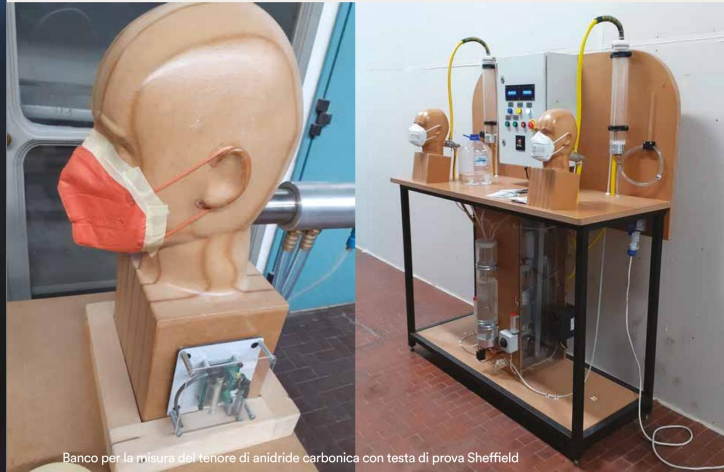
Banco per la misura del tenore di anidride carbonica con testa di prova Sheffield
