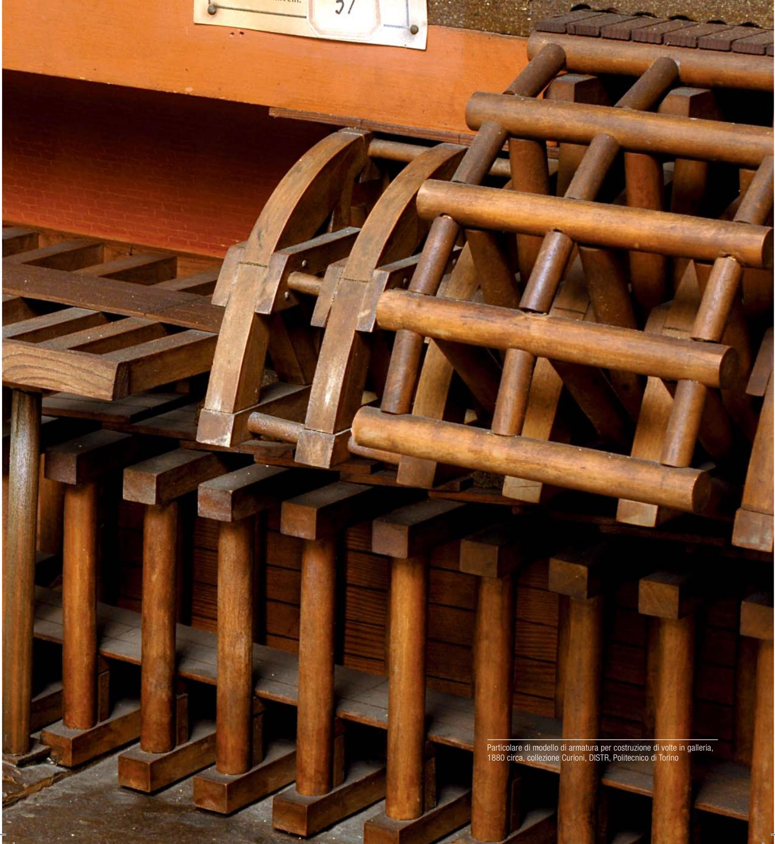
Particolare di modello di armatura per costruzione di volte in galleria, 1880 circa, collezione Curioni, DISTR, Politecnico di Torino
