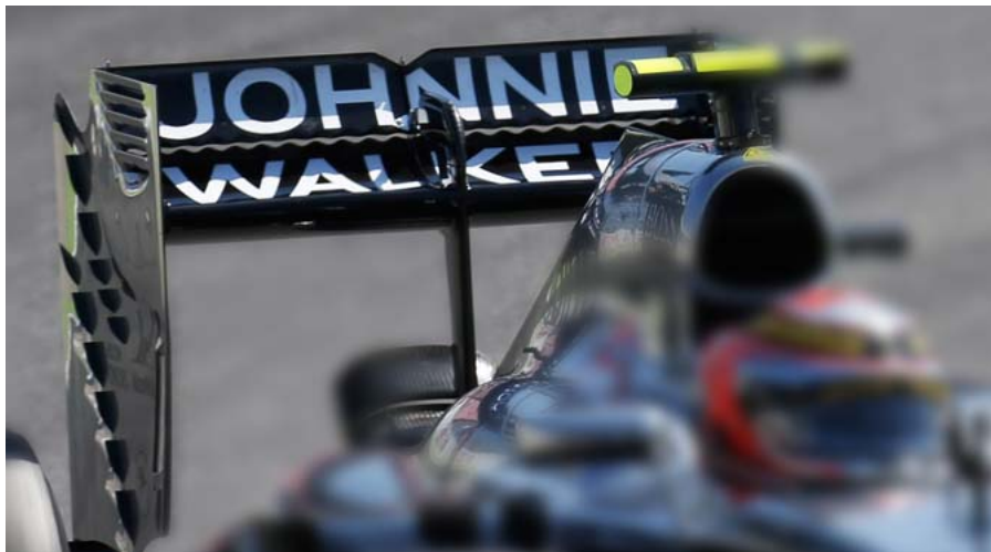
Figura 27: Bordo di fuga dell'alettone principale e bordo di attacco del DRS con andamento sinusoidale, rear wing McLaren MP4-29. Photograph obtained from www.newsfl.it
