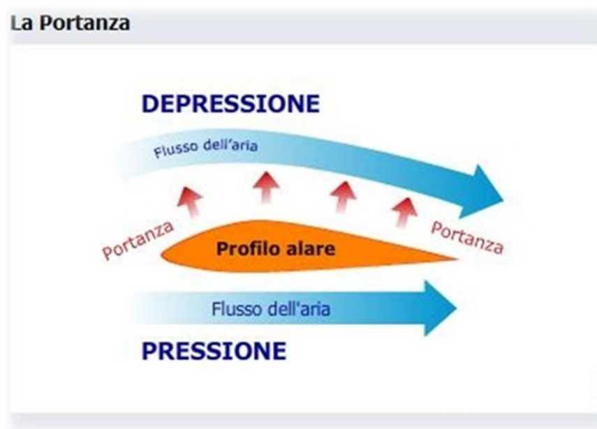
Figura 2.2: Profilo investito da flusso d'aria che genera portanza
