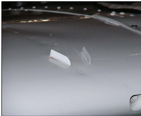
Figura 4.4: generatore di vortici Micro Dynamics montato sull'ala di un Cessna 182K.
