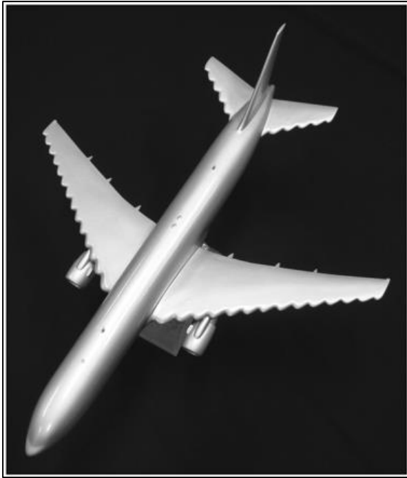
Figura 4.15: modello di aereo jet commerciale con tubercoli sulle ali e sull'impennaggio orizzontale. L'aggiunta di tubercoli potrebbe potenzialmente migliorare la sicurezza e ridurre i costi del carburante.
