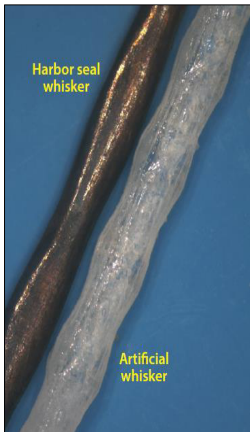
Figura 3.5: confronto tra un sensore che riproduce la forma della vibrissa di una foca portuale e una vera e propria. La larghezza massima nel modello in figura è di 1,15 mm.
